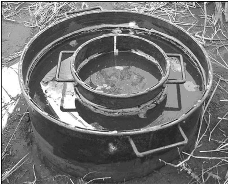
Figura 54. Ensaio de infiltração de água utilizando os anéis concêntricos.
